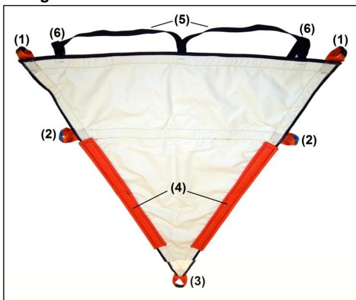
La toile de sauvetage sert à remonter et à descendre des personnes (sauvetage des hauteur ou profondeur) en position assise. Placer la toile de sauvetage sur le dos de la personne à sauver, passer les 2 boucles de suspension (1) sous les aisselles pour les amener sur l'avant, tirer la boucle de suspension centrale (3) avec l'anneau de sangle pré-assemblé entre les jambes vers le haut. Passer **CHACUNE DES 3 (!)**
